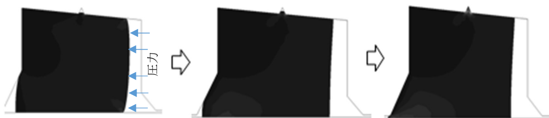
図6 ピストンシールの変形状態
