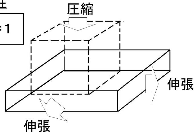
一般的に圧縮変形するゴムを伸張試験で材料定義可能なのは、この非圧縮性を前提としているからです。
